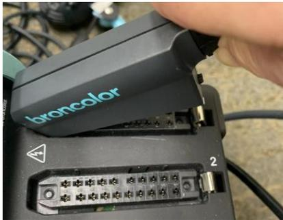
要拆除插头时，先向后拉动插头后端的的安全铁片扣，再把插头拔出。
